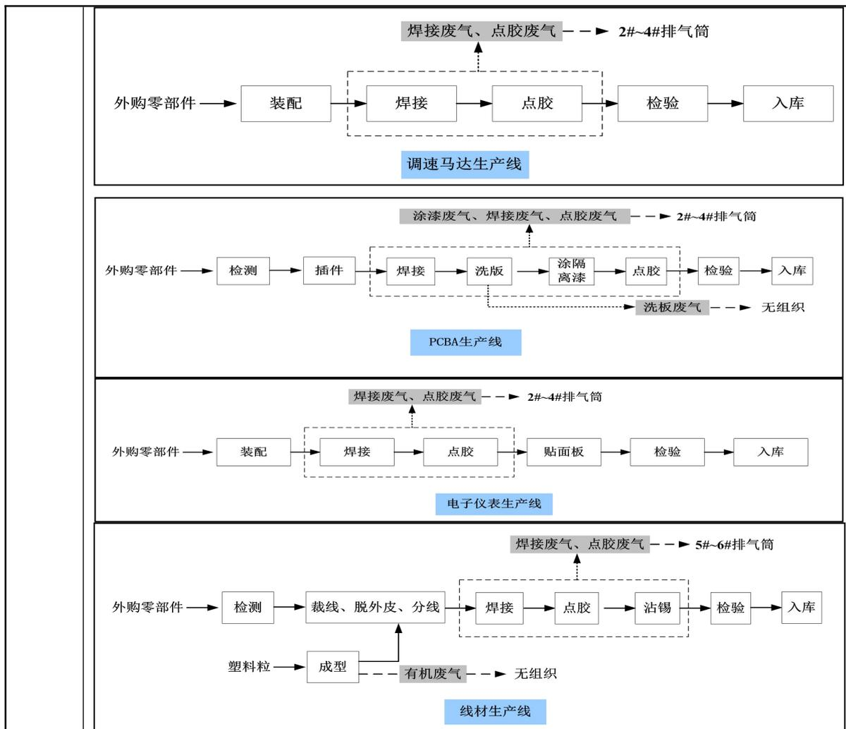
图 2 本项目生产工艺流程及产污节点图
