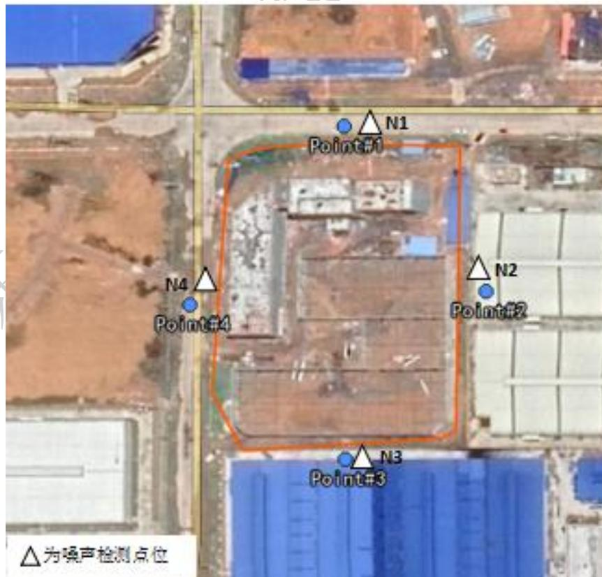
图7 声环境现状采样点位示意图（N：噪声）
