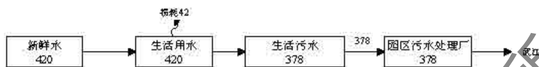
图 1 本项目水平衡图 单位： \text{m}^3/\text{a}
